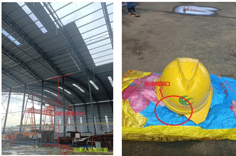
图 4 高处坠落相对高度示意图及安全帽图片
