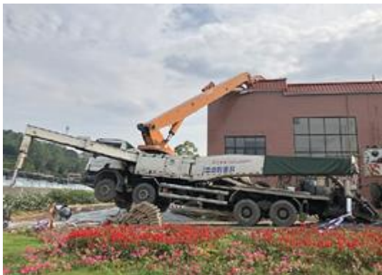
图 10、泵车失稳倾侧
